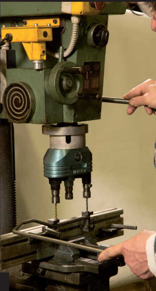
Operazione di foratura multipla su pezzi piegati
